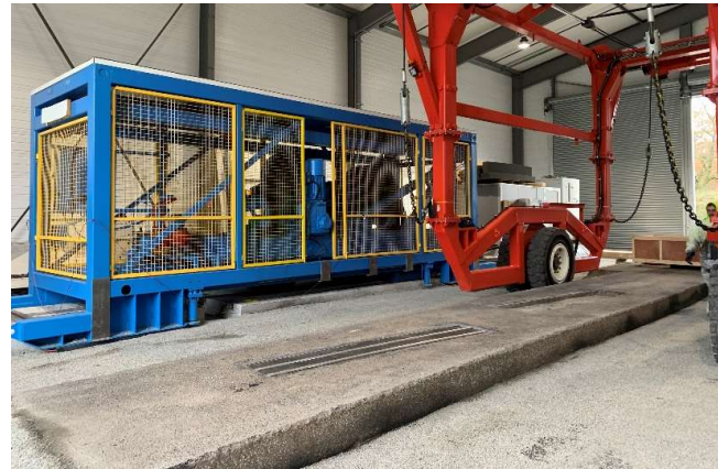
Essai avec le simulateur de trafic FABAC (roues jumelées chargées à 65 kN)
